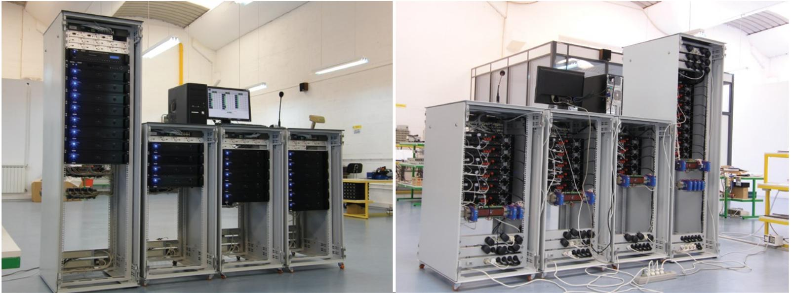
O sistema, composto por dois bastidores de potência e um de controlo com o servidor durante a fase de testes, antes da instalação no C.C.Colombo
